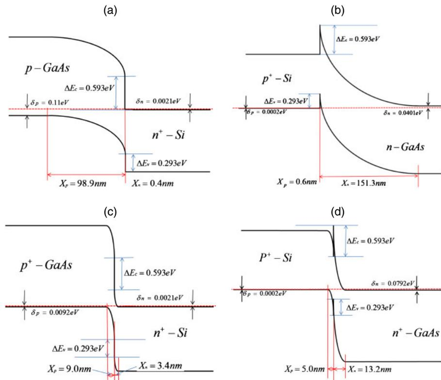
Fig. 7. (Color online) Schematic energy-band diagrams of (a) p-GaAs/n<sup>+</sup>-Si, (b) p<sup>+</sup>-Si/n-GaAs, (c) p<sup>+</sup>-GaAs/n<sup>+</sup>-Si, and (d) p<sup>+</sup>-Si/n<sup>+</sup>-GaAs junctions.
